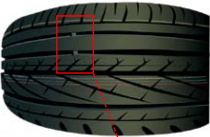
TWI (ang. Tread Wear Indicator) – wskaźnik zużycia opony, określający graniczną wartość 1,6 mm.
